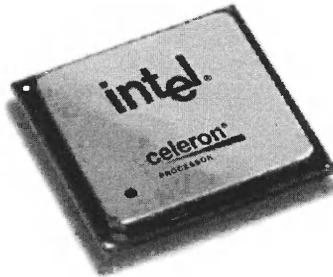
Эта модель построена на ядре Northwood, выпускается в корпусе типа FC-PGA2, имеет кэш-память L2 объемом 128 Кбайт и поддерживает системную шину с эффективной частотой 400 МГц. Производится по 0,13-микронной технологии, устанавливается в стандартный разъем Socket 478.
